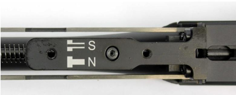
Schaftaufnahme am Systemkasten ansetzen und mit den beiliegenden Befestigungsschrauben (M5x10 SW 3) leicht fixieren. Anschließend die Schaftaufnahme mittig ausrichten und die Schrauben fest anziehen.
