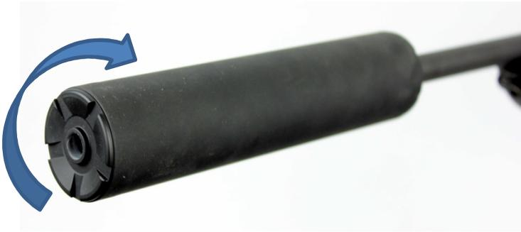
Schieben Sie den Schalldämpfer vorsichtig auf den Lauf. Drehen Sie den Schalldämpfer im Uhrzeigersinn auf den Lauf und ziehen Sie diesen handfest an. Vor dem Aufschrauben des Schalldämpfers sollte das Laufgewinde sowie die Kontaktflächen leicht gefettet werden.
