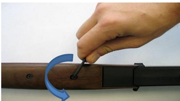
Die beiden Befestigungsschrauben entgegen dem Uhrzeigersinn lösen und den Vorderschaft nach vorne abnehmen. Innensechskant SW3
