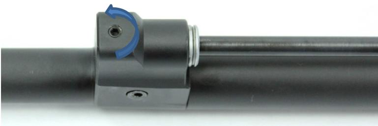
Gewindestift M4x4 (SW 2) durch drehen entgegen dem Uhrzeigersinn demontieren. Gewindebohrung ggf. säubern und leicht einölen.
