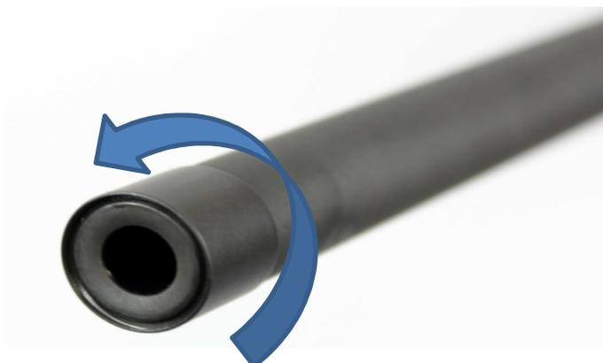
Das angebrachte Mündungsgewinde wurde durch den mitgelieferten Gewindeschutz geschützt. Diesen Gewindeschutz nun entgegen dem Uhrzeigersinn von der Mündung schrauben.
