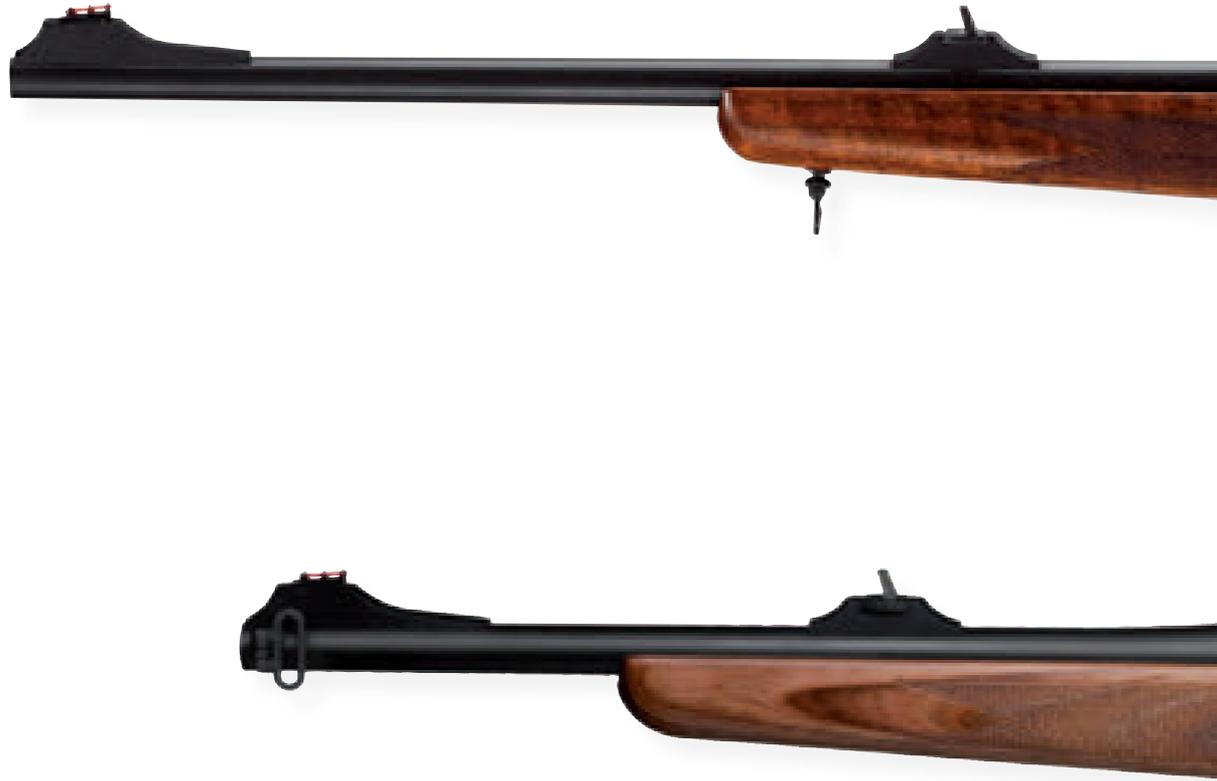
■ **REPETIERBÜCHSE KR1 BASIC:** Sechs-Warzen-Drehkopfverschluss mit kleinem Öffnungswinkel | Dreistellungssicherung auf dem Kolbenhals | Kombiabzug mit Rückstecher | Magazinkapazität 3+1 (2+1 für Magnumkaliber) | Gerader Schaft mit Pistolengriff ohne Backe | Gummischaftkappe
