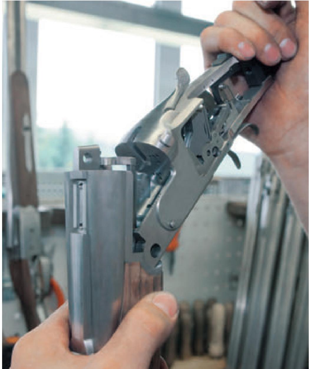
■ Muss satt sitzen: Toleranzfrei zusammengefügtes Drillings-System.
