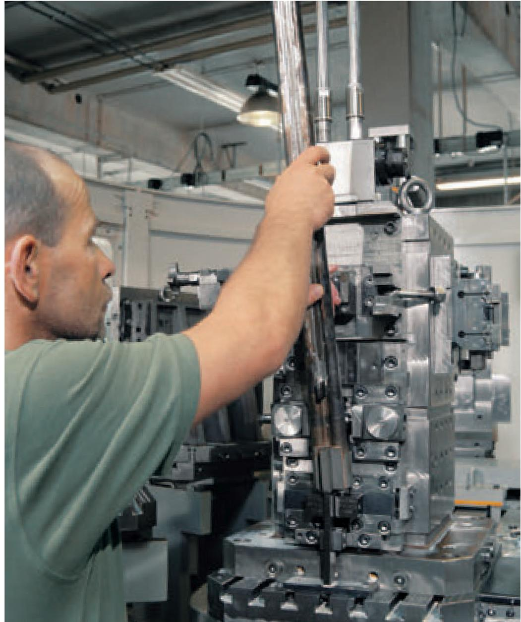
Handwerk trifft Hightech: Handverlöteter Lauf wird in die CNC-Fräsmaschine eingespannt.
