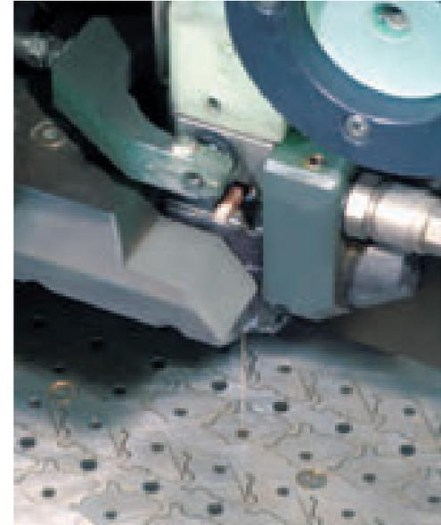
Drahterodieren – Prinzip Drahtsäge.
