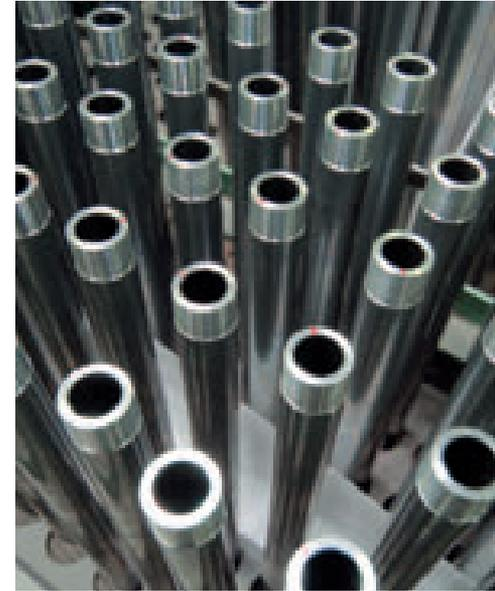
Schrotlauf-Rohlinge in der Fertigung.
