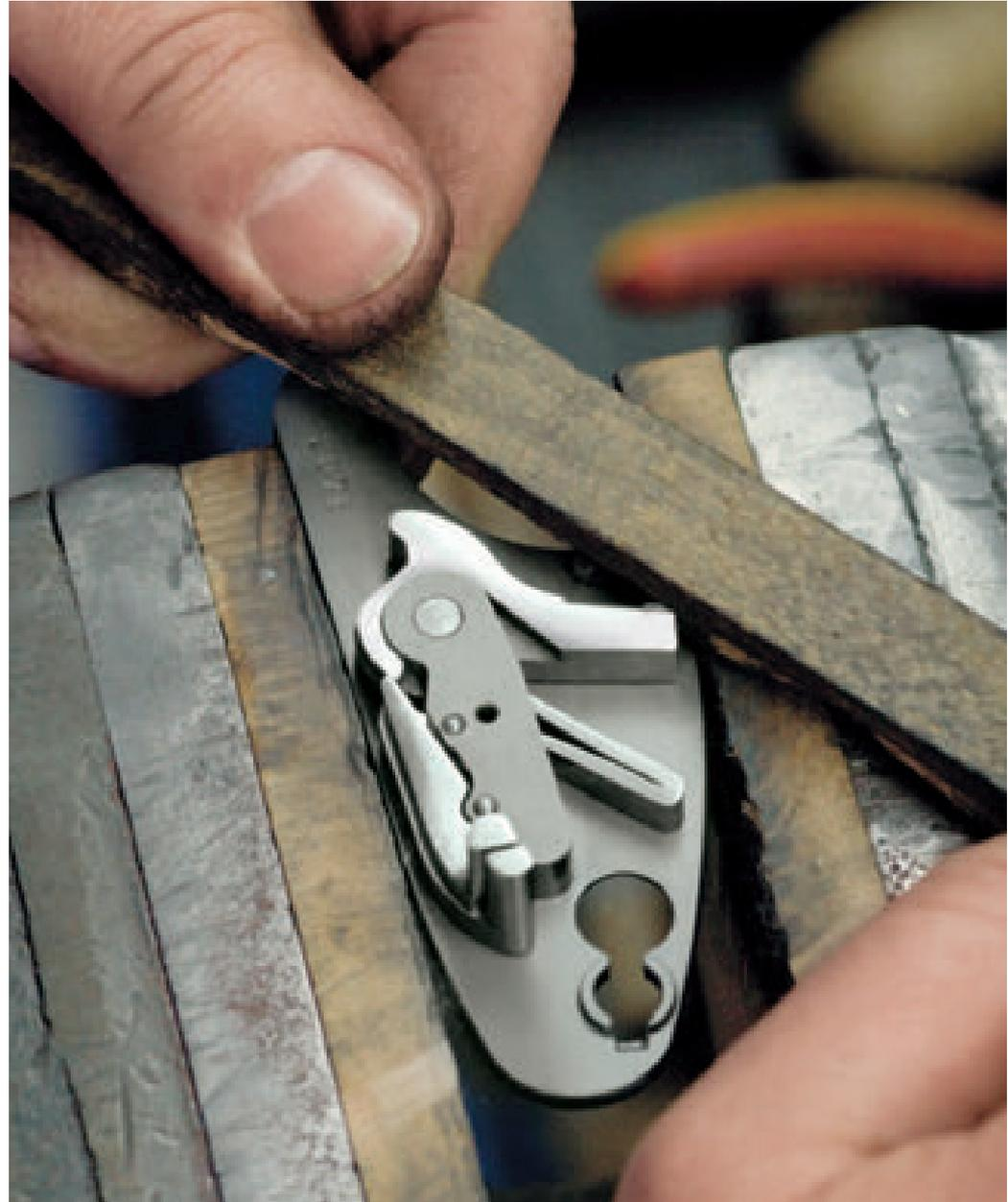
Der Schwarzmonteur spannt die Bugfeder des Seitenschlosses.
