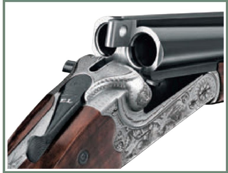
Verschluss nach Greener mit doppelter Laufhakenverriegelung.
