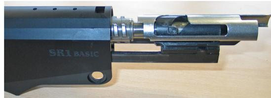
Beim Einführen muss der Steuerbolzen in vorderster Stellung sein.
