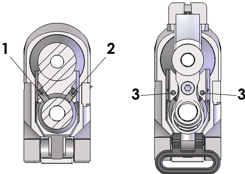
Zunächst müssen die Konter-schrauben 3 gelöst werden (Drehung entgegen Uhrzeigersinn)
